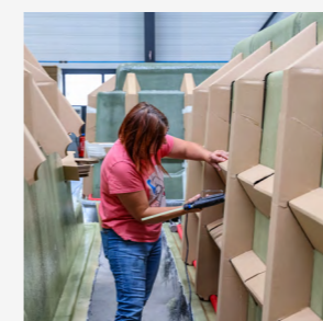
5. Mise en place des pré-formes de renfort pour la stabilité du bassin
